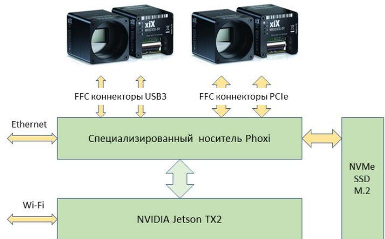
Интерфейсы вычислительного графического модуля NVIDIA Jetson TX2 со специализированным носителем Phoxi:
